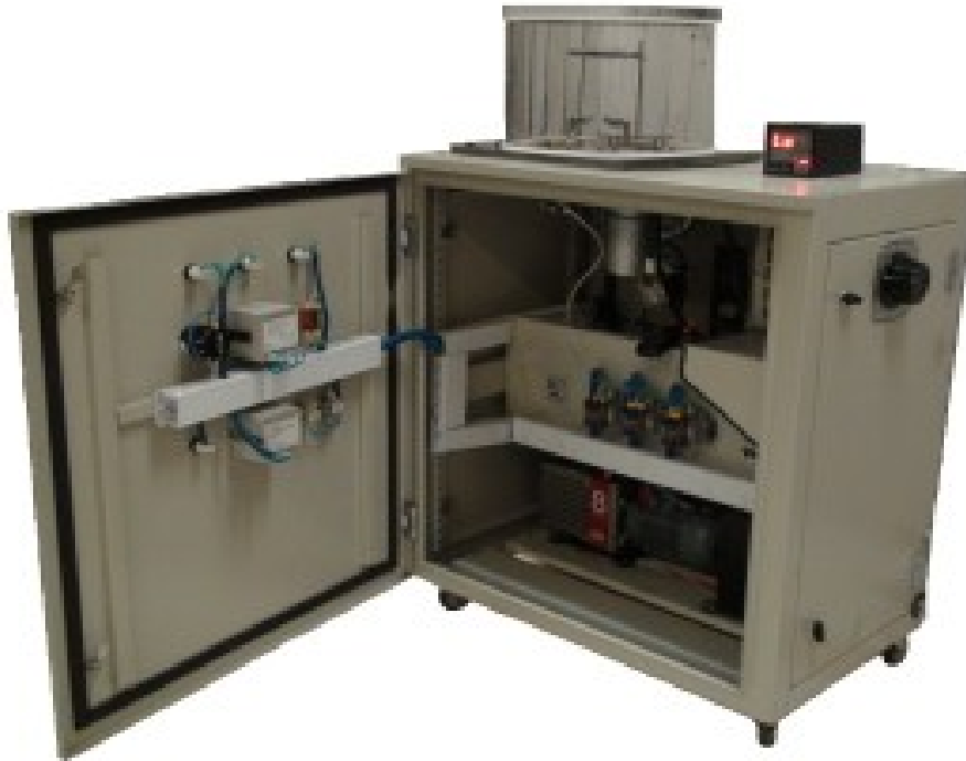
نمای سامانه لایه نشانی با محفظه شفاف پلیمری
